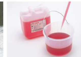
▶ (硬化剤添加) ●[ポリルーフS-2β]に硬化剤を混合する。 (SC硬化剤1~2%混合)
