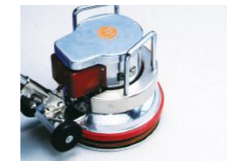
▶ 下地処理 ●下地処理チェック項目(P45)に従い、ウレタン防水に適した下地作りを行う。
