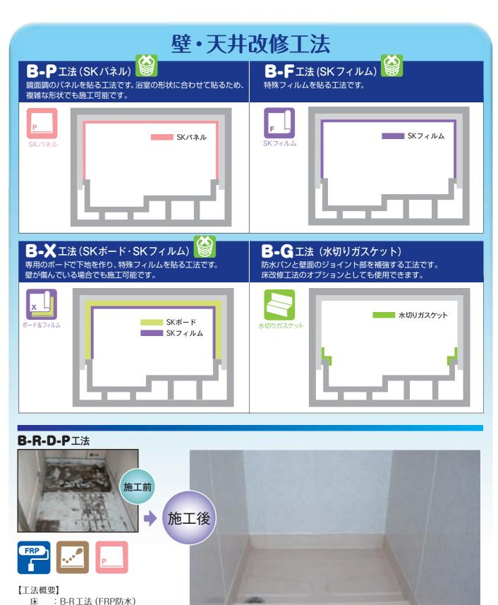
床仕上げ: B-D 工法 (SKドライパネル) 壁・天井: B-P 工法 (SKパネル)
